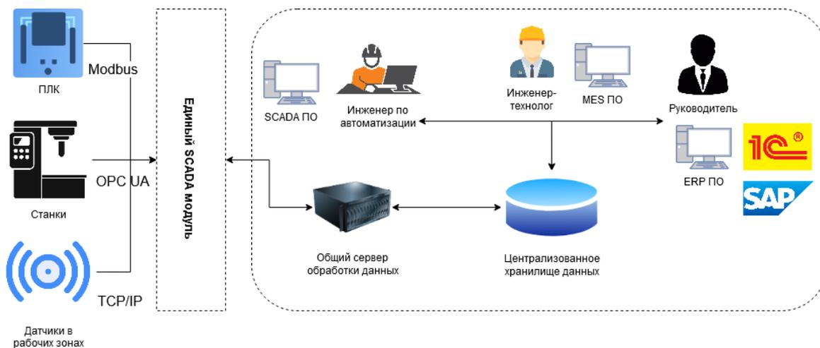
Рис. 1. Модель применения монолитной архитектуры программного обеспечения на производстве
