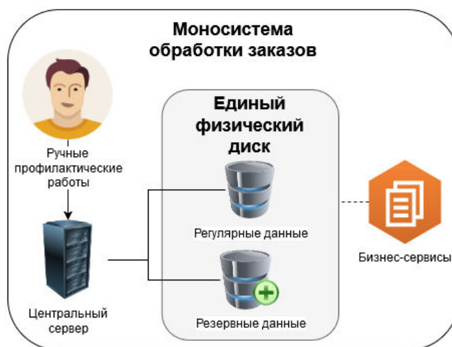
Рис. 4.5 – Смоделированная ИТ-архитектура на момент сбоя Toyota в августе 2023
