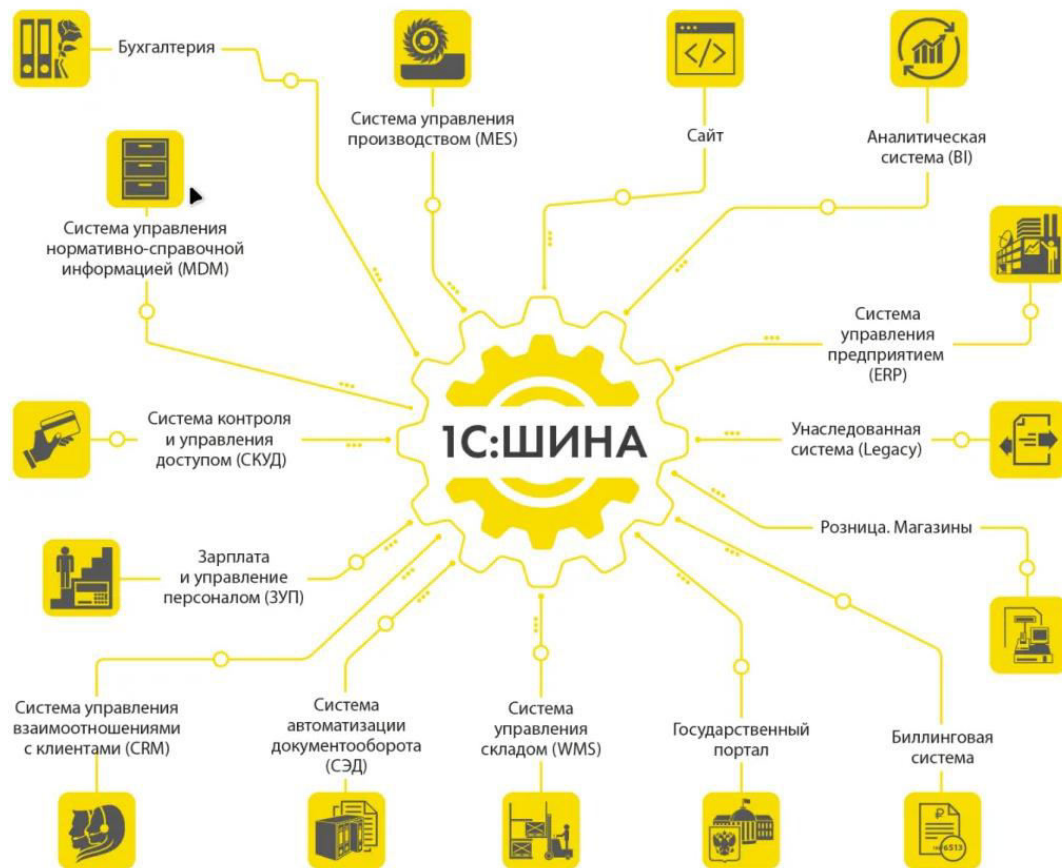
Рис. 2.6 – Готовое решение ESB – 1С:Шина для консолидации интегрированных систем
